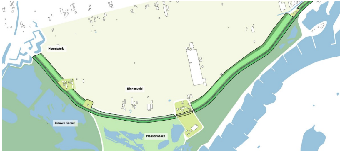
Afbeelding 4.16 Bovenaanzicht ontwerpprincipie landelijke dijk (Feddes/Olthof, 2024): smalle en brede binnenbermen
