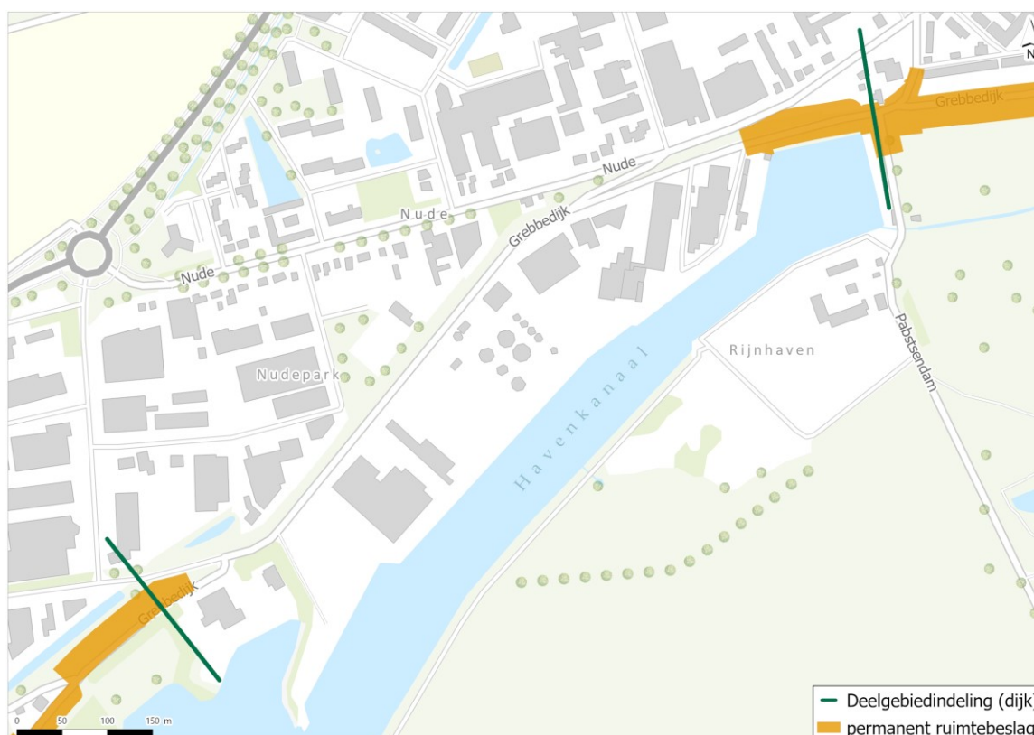
Afbeelding 4.13 Bovenaanzicht permanent ruimtebeslag dijkontwerp Nudedijk
