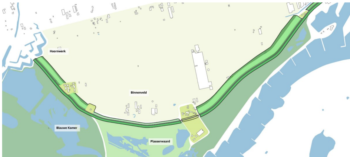
Afbeelding 2.5 Bovenaanzicht dijkontwerp landelijke dijk
