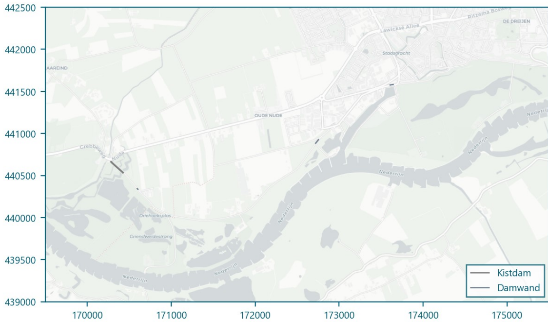
Afbeelding 3.8 Bestaande verticale schermen in de referentiesituatie in de 1 e modellaag
