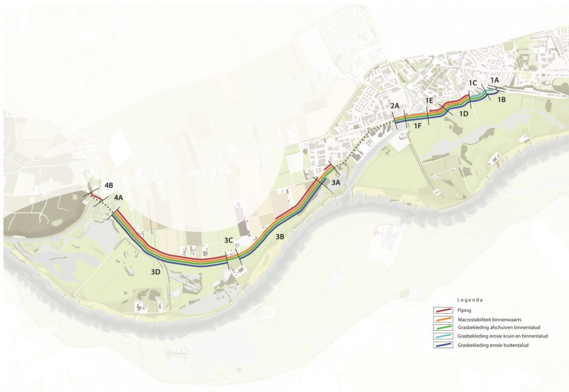
Afbeelding 2.2 Belangrijkste faalmechanismen Grebbedijk per dijkvak
